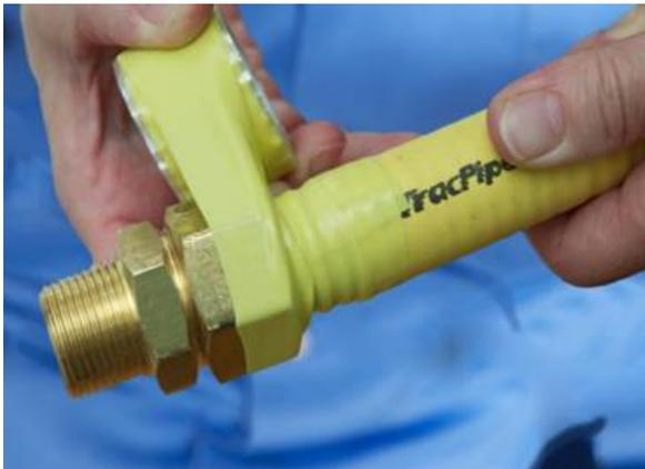
Après s'être assuré que la connexion est étanche au gaz, la partie non protégée du tuyau PLT entourée avec de la bande silicone autovulcanisante TracPipe® (résistante aux UV). La partie en acier inoxydable visible et la recouvertes. On évite ainsi les risques de corrosion.
