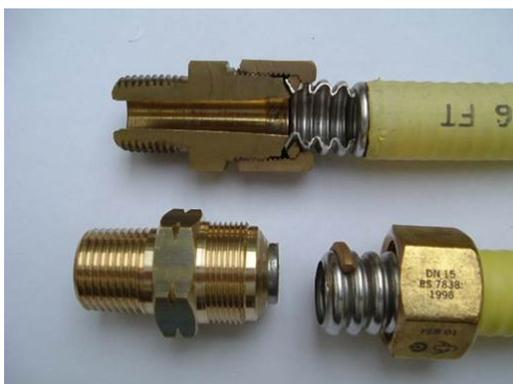
Le raccord AutoFlare<sup>®</sup> est maintenant vissé manuellement dans l'écrou. Avec les clés appropriées, l'écrou est encore resserré jusqu'à ce que le raccord soit fixé et que la résistance au serrage augmente considérablement. Pour réaliser la jonction, l'écrou doit finalement encore être resserré de 1/3 de tour ou de deux plats d'écrou supplémentaires. Maintenant, le bord du tuyau TracPipe<sup>®</sup> est évasé et on obtient une étanchéité métal-métal.
